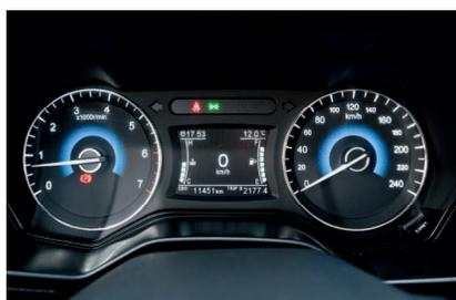
Жидкокристаллический дисплей в комбинации приборов читается хорошо, а вот оцифровка шкал могла бы быть покрупнее
