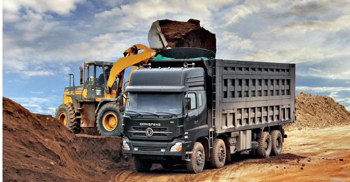
Тяжелые самосвалы DFM KC грузоподъемностью от 20 до 33 тонн оказались самыми востребованными на российском рынке. Они оснащены дизелями Cummins мощностью 340 л.с., либо 375 л.с.
